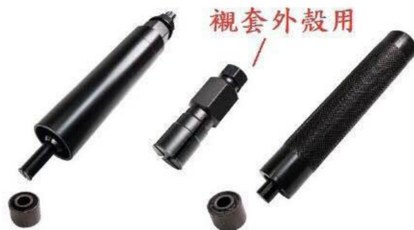
二代GOGORO 後輪橡膠襯套拆裝器
