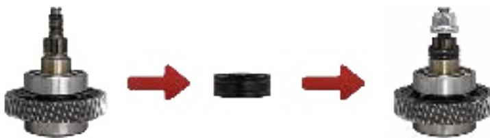
安裝時，先將定距套管放入，再依序安裝前帶輪步驟
