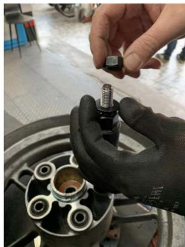
拆卸工具外筒放入，將墊片、螺母鎖緊
