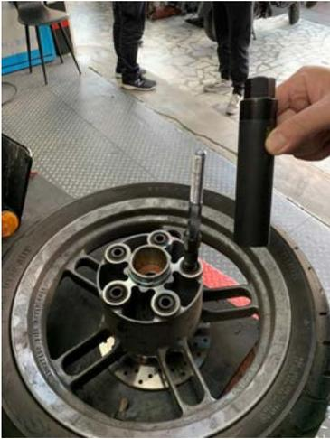
拆卸襯套工具插入原廠襯套內 將工具鎖緊
