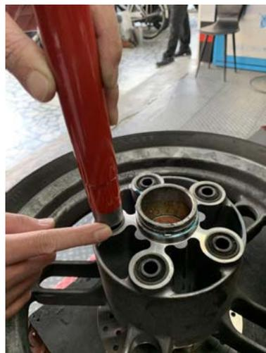
將改裝螺柱襯套放入安裝工具
